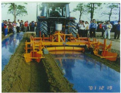
谷林牌南改型築畦塑膠布鋪設機
