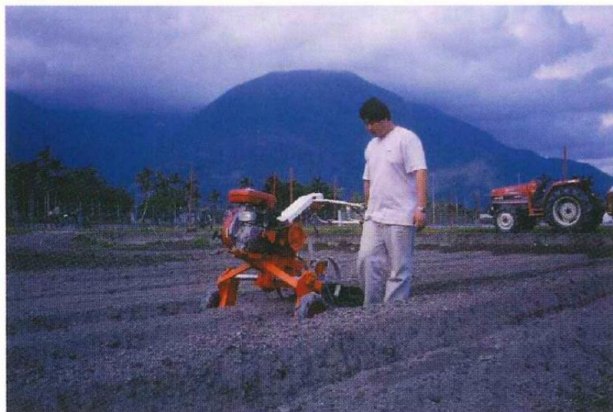
圖十九 承載型直播機畦上作業情形
