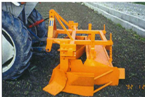
圖五 韭菜植溝作業機具
