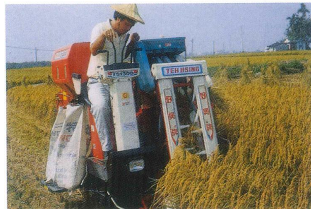
圖五 水稻聯合收穫機附掛豆類播種機
