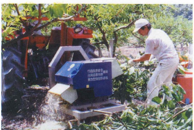
圖十四 曳引機附掛式殘枝粉碎機
