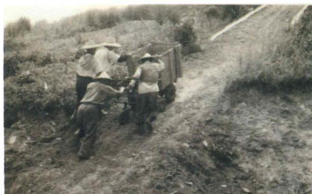
圖三 早期由日本引進之三輪式動力搬運車在爬坡試驗場進行爬 40% 陡坡試驗情形
