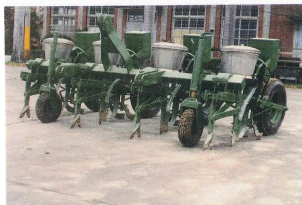
圖六 曳引機之不整地玉米播種施肥機
