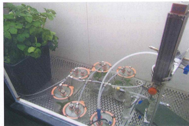
圖四 以昆蟲觸鬚做植物氣息與生理狀態感測器之昆蟲與系統
