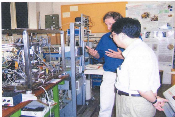
圖三 光聲效應的雷射高靈敏度生物氣息感測系統
