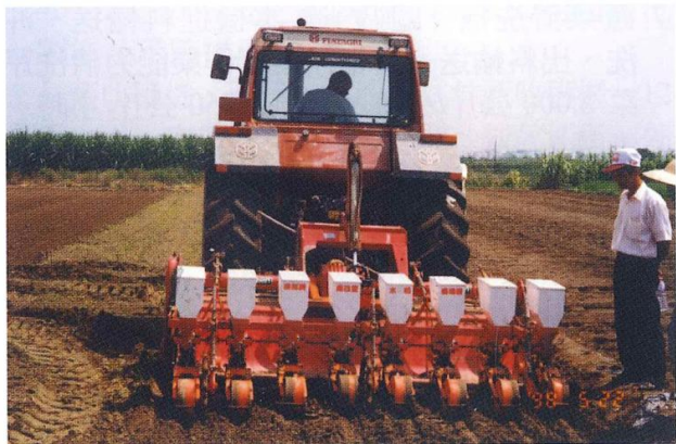
圖二 曳引機承載式水稻直播機
