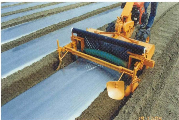
圖七 RM-120S 築畦塑膠布鋪設機
