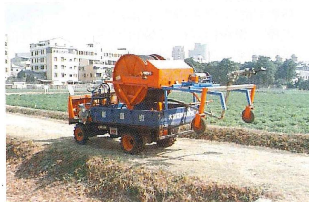
圖五 捲管式田間自動噴灌機
