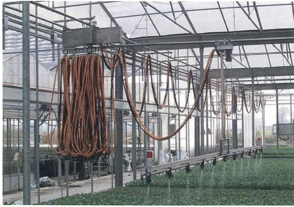
圖十一 自動換棟型懸吊桿式噴霧系統
