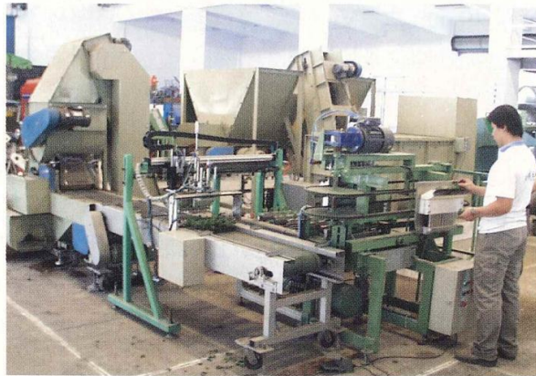
圖十二 菊花穴盤苗自動插苗機
