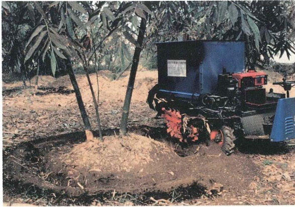
圖三 自走式挖環溝施有機肥機
