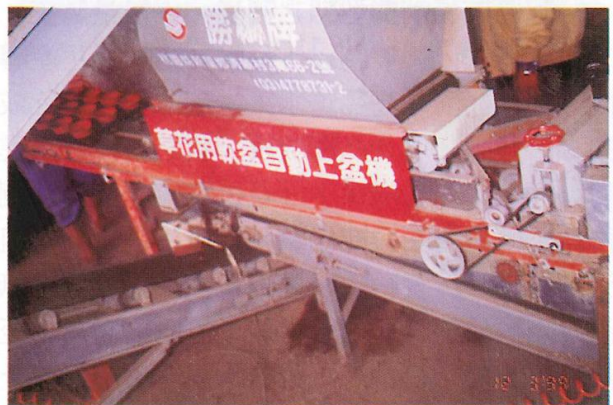
圖七 混拌上盆機介質回收作業
