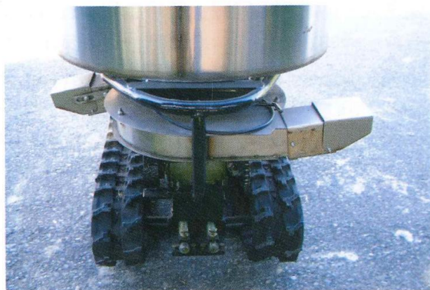
圖二 履帶式施肥機撒布盤肥料出口可調整角度之構造
