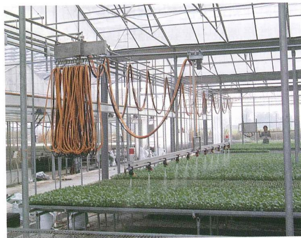
圖四、裝設於彰化縣二林鎮連發自動化育苗場示範使用之換棟型懸吊桿式自動噴霧系統
