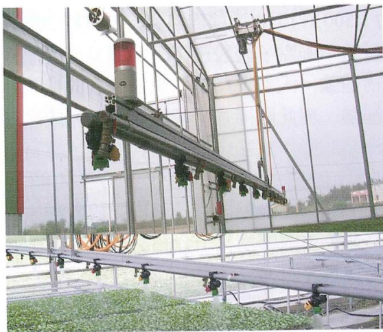
圖二、該系統特點因只使用一組噴桿，故不必擔心多組噴桿會累加成本，而可使用最高級噴頭或如圖中使用噴藥與噴灌之雙噴頭組噴桿，更可達成全區每一棟都能同樣噴施均勻；下半圖為其在實際操作噴霧時情形
