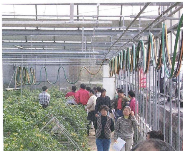
圖五、裝設於台中縣東勢鎮立農自動化育苗場示範使用之換棟型懸吊桿式自動噴霧系統
