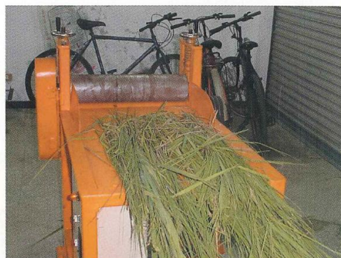
(3) 壓潰機作業情況
