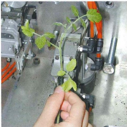
圖三 根砧往上切除，產生出一嫁接斜切面
