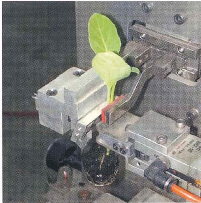
圖二 根砧置入後，踩下踏板自動夾取
