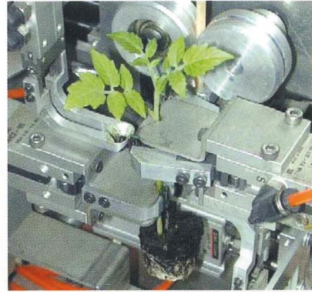
圖六 根砧和接穗插入橡膠軟管內完成嫁接動作
