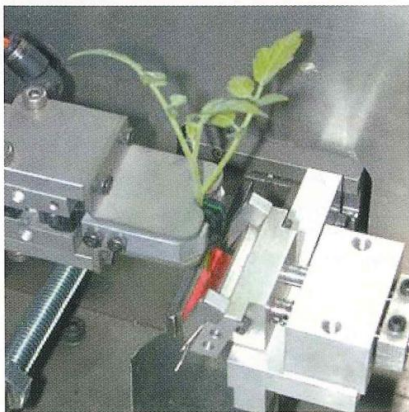
圖四 接穗置入後，踩下踏板自動夾取
