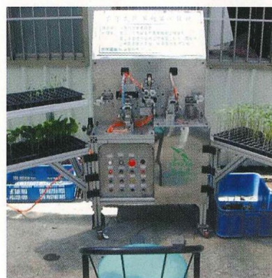
圖一 套管式嫁接機全貌
