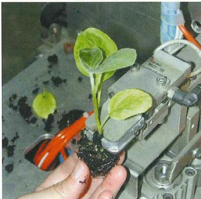
圖五 接穗往下切除，產生出一嫁接斜切面
