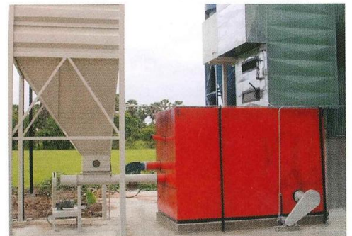
粗糠燃燒爐/熱交換式熱源
