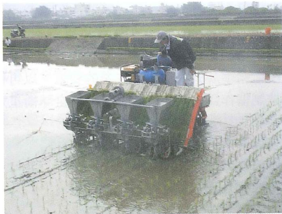
圖 4 可變率深層施肥雜型機在農試所試驗田區作業情形
