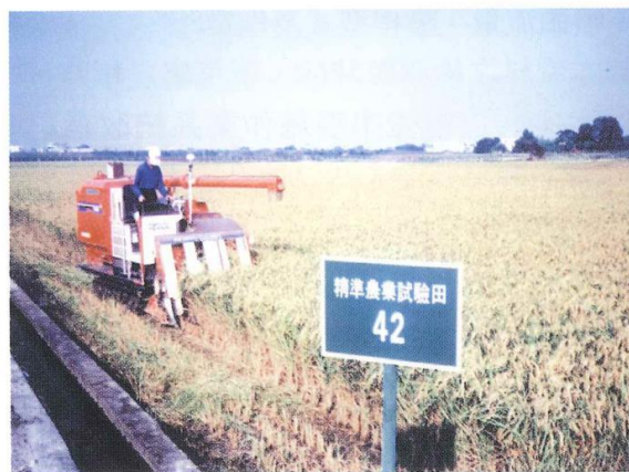
圖 5 產量偵測用收穫機於農試所測試情形
