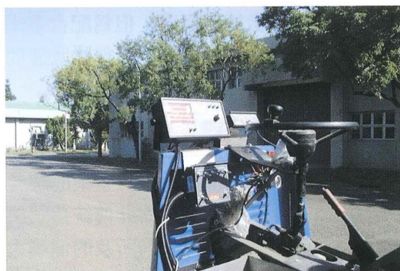
▲在農試型氣輔桿式噴藥機上安裝雷射測速器、變率控制系統及主控模組。
