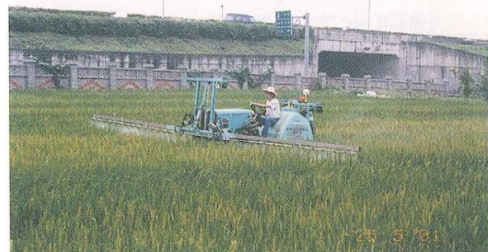
▲台大生機系研發之衛星定位變量噴藥系統進行定點噴施作業
