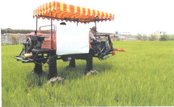
圖 1 稻株含氮量地面多光譜影像遙測系統於田間實測之情形
