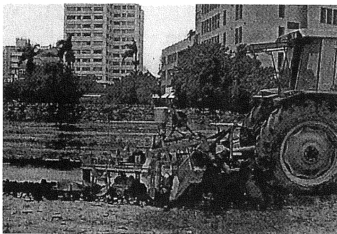
圖二 RM240 型築畦塑膠布鋪設機一次可完成開溝、築畦、塑膠布鋪設，也可同時完成地下害蟲藥劑及噴灌水帶的鋪放
