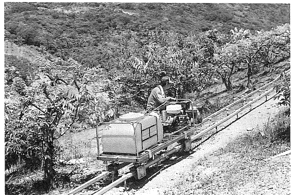
圖 2 新型動力雙軌車在台東縣太麻里坡地鳳梨釋迦果園載運藥液上坡情形
