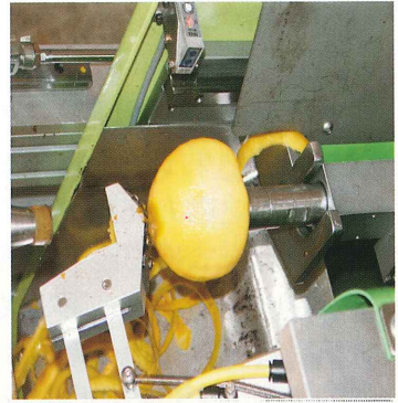
圖六 削皮至果尖處，頂桿脫離以利削皮
